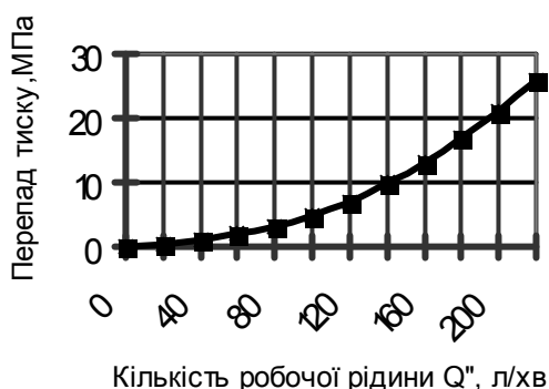
Рис. 4. Тарувальна характеристика витратоміра змінного перепаду тиску
