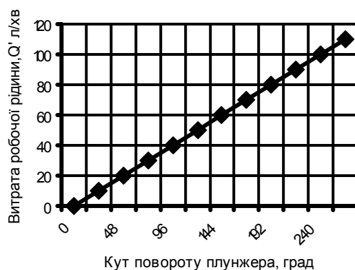
Рис. 2. Тарувальна характеристика витратоміра постійного перепаду тиску
