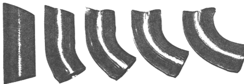
Рис. 3. Поетапне деформування заготовки відведення 90^\circ 45 \times 2,5
