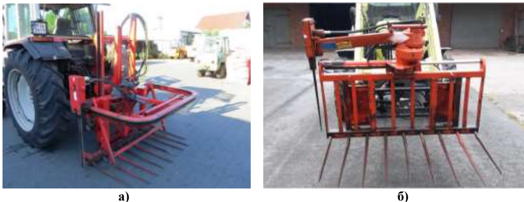
Рис. 3. Відрізні механізми стеблових кормів: а) відрізний механізм заднього навішування з горизонтальними ножами, б) відрізний механізм фронтального навішування з черенковим ножом
