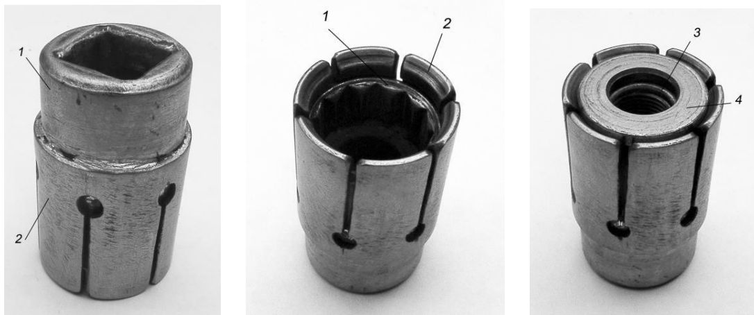
Рисунок 3.7 – Головка для захоплення гайки з шайбою із касети: 1 – стандартна головка; 2 – цанговий тримач шайби; 3 – гайка М11×1; 4 – шайба 11.
