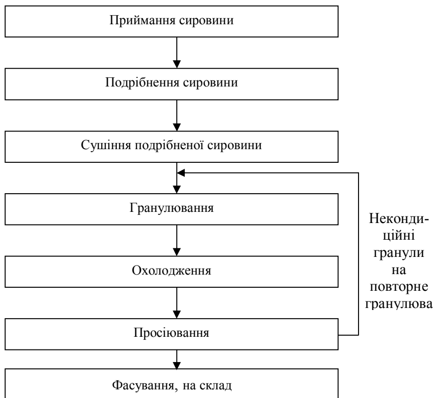
Рис. 1. Технологічна схема виробництва паливних гранул
