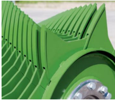
Рис. 14 - Розташування зубів на АХ (25 мм) та МХ (17 мм)
