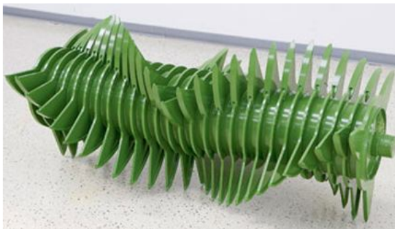
Рис. 10 – Живильний ротор прес-підбирача Big Pack 1290 HDP
