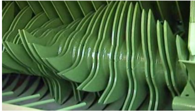
Рис. 7 – Живильний ротор прес-підбирача Round Pack 1250, 1550 Multi Cut
