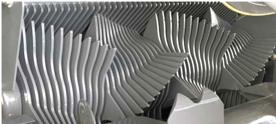
Рис. 2 – Живильний ротор Roto Cut прес-підбирача Quadrant 3200 FC
