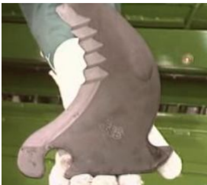
Рис. 8 Вигляд ножа різального пристрою Multi Cut
