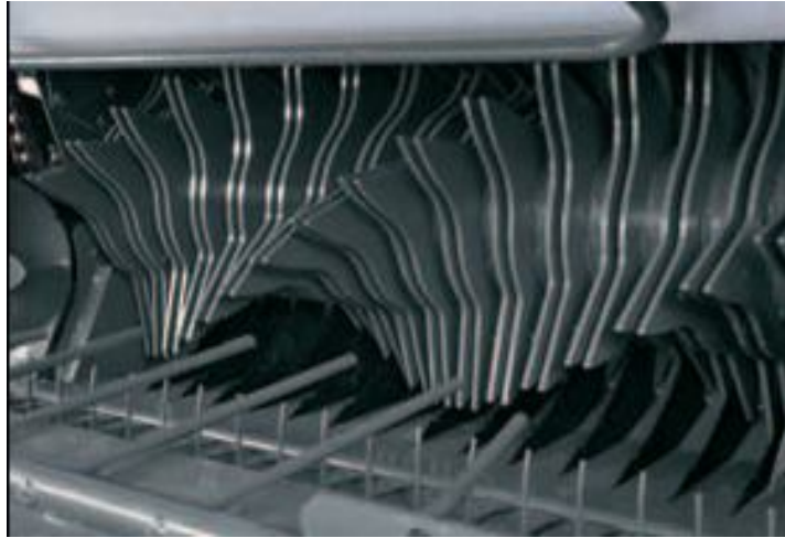
Рис. 1 – Живильний ротор Roto Cut
