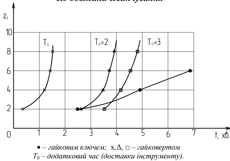
Рис. 3. - Залежність часу відгвинчування болтів (t) M12 від кількості різьбових з'єднань ( z_p ) при довжині згвинчування l=25 мм.
