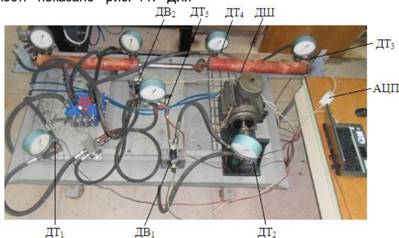
Рис. 11. Стенд для імітаційного моделювання та дослідження роботи відокремлювача стеблових кормів
