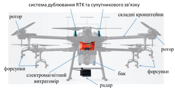
Рис. 2. Схема розташування основних елементів Agras T16
