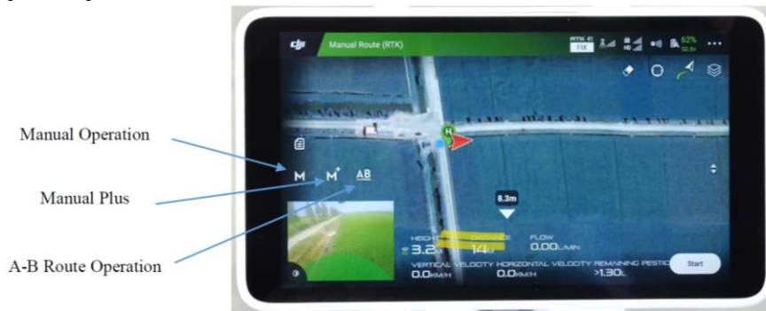
Рис. 5. Відображення режимів роботи на пульті дистанційного керування Agras T16
