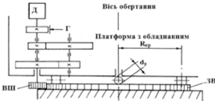
Рисунок 1.19 – Кінематична схема механізму повороту ( Д – двигун; Г – гальмо; Р – редуктор; ВШ – ведуча шестерня; ЗВ – зубчатий вінець)
