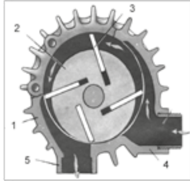
Рисунок 3.23 – Схема ротаційного вакуум-насоса УВД (1 – корпус; 2 – ротор; 3 – лопатка; 4 – патрубок всмоктування; 5 – патрубок нагнітання).
