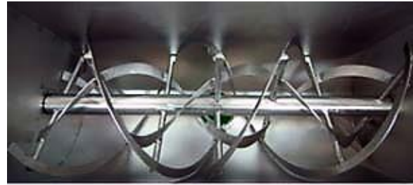
Рис. 8. Вал з двома стрічками конструкції типу «S»
