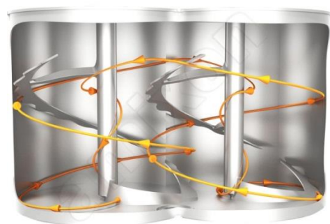
Рис. 10. Вертикальний двовальний стрічковий змішувач а) та схема циркуляції продукту б)
