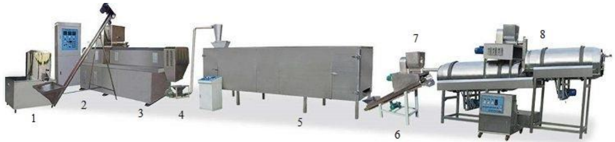
Рис. 4. Технологічна лінія виробництва кукурудзяних снєків: 1 - змішувач; 2 - шнековий конвеєр; 3 - екструдер; 4 - повітряний транспортер; 5 - сушарка; 6 - транспортер; 7 - обприскувач; 8 – охолоджувач
