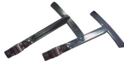
Рис. 6. Вал та робочі органи конусного змішувача
