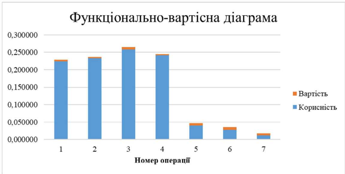
Рисунок 7.6. Функціонально-вартісна діаграма процесу формоутворення заготовок 1 – навішування; 2 – спосіб ВУП; 3 – режим ВУП; 4 – функціонування ГП; 5 – функціонування рухомих ланок ІВПМ; 6 – функціонування віброзбуджувача; 7 – функціонування прес форми
