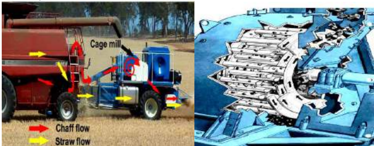
Рис. 6.25. Схема деструктора Харрінгтона (ліва позиція) та блок його подрібнювача (права позиція) (джерело: Walsh et al. 2012).
