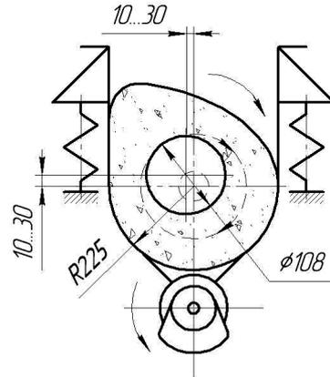
Рис. 7. Перемещение детали во время обработки
