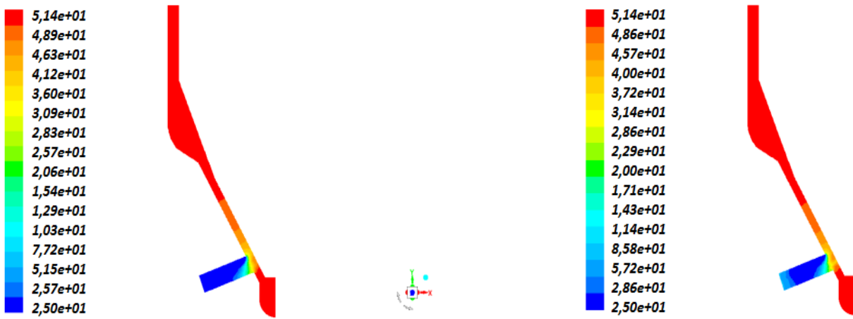
Рис. 5. Розподіл тиску палива в поздовжньому перерізі всієї проточної частини досліджуваного розпилювача при протитиску p_{\text{налив вих}} = 0,1 \text{ МПа} (а) і p_{\text{налив вих}} = 8,878 \text{ МПа} (б)
