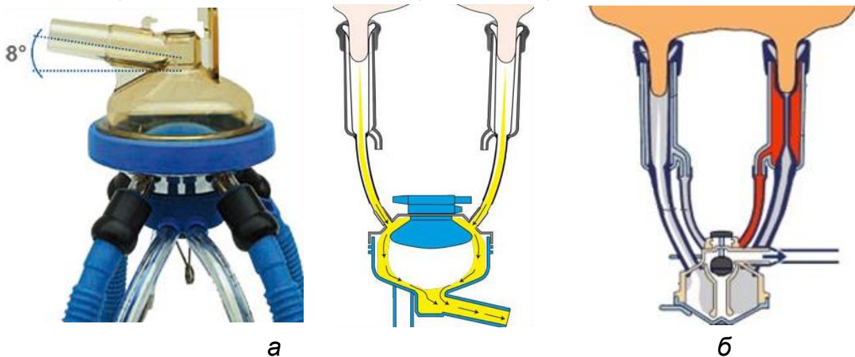
Рис. 1. Конструкційні рішення підвищення ефективності колекторів: а – колектор Milpro 450 (Італія); б – колектор MC-50 (Швеція)
