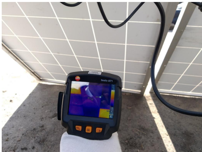
Рис. 1. Моніторинг стану сонячних панелей за допомогою тепловізора
