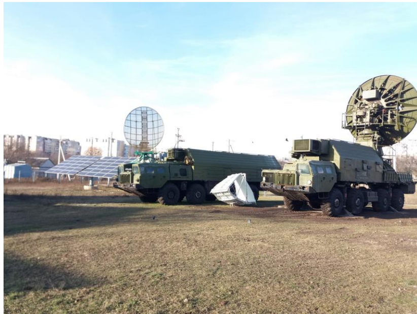
Рис. 3. Система приймання інформації середньої роздільної здатності на базі командно-вимірювальної системи «Фазан» з діаметром дзеркала 5 м.
