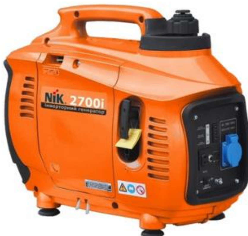
Рис.3. Резервний бензиновий модуль NIK 2700i з інверторним генератором, як один із елементів даної САПЕРС (потужність 2,7 кВт, витрати пального 0,9 л/год, рівень шуму до 77 дБ, об'єм двигуна 118 см 3 , час безперервної роботи до 3,5 годин, вартість 19,6 тис. грн) [3]
