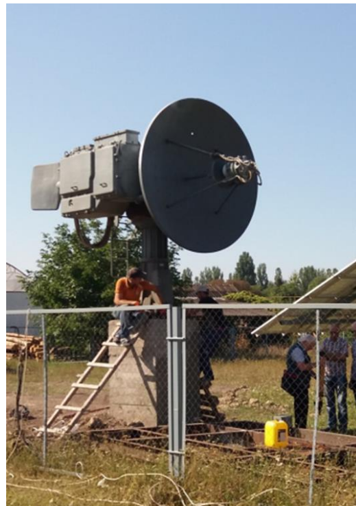
Рис. 2. Система приймання інформації середньої роздільної здатності на базі антенної системи діаметром 2,5 м
