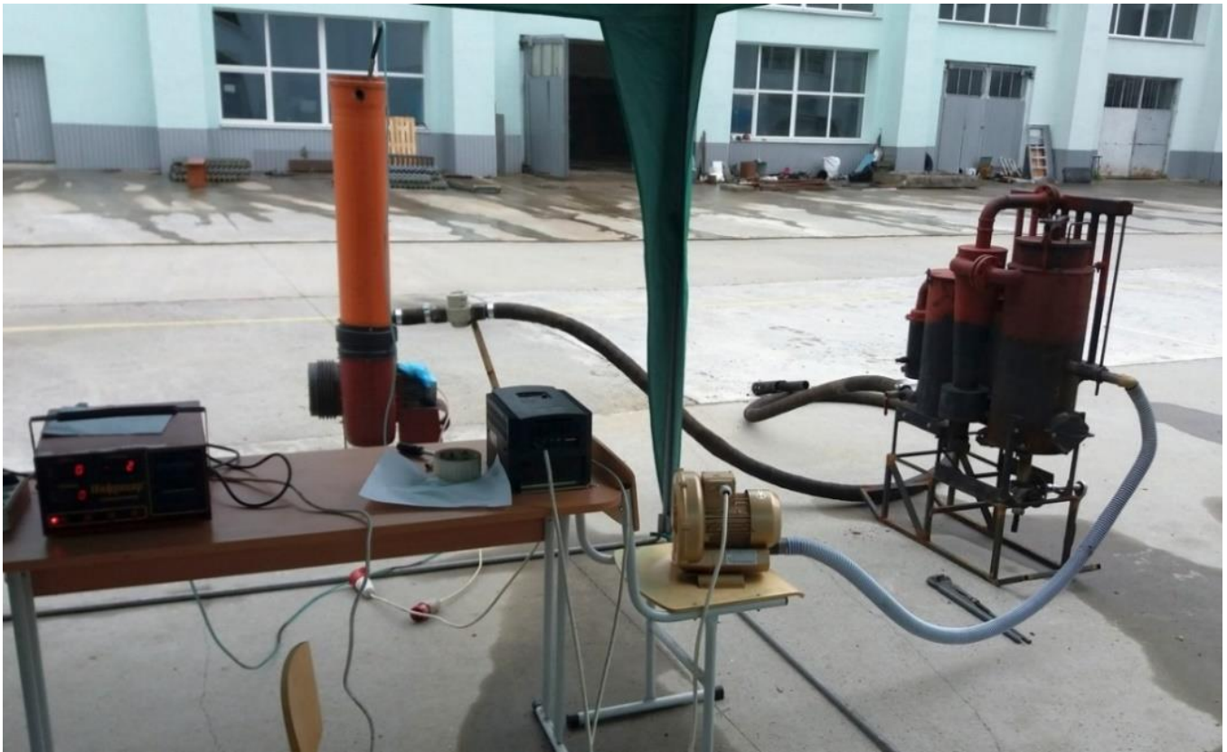
Рис. 2. Фото установки для дослідження та об'ґрунтування параметрів роботи газогенератора
