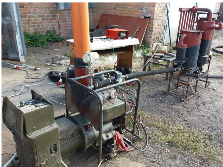
Рис. 5. Фото установки для експериментальних досліджень щодо виробництва електричної енергії на основі генераторного газу
