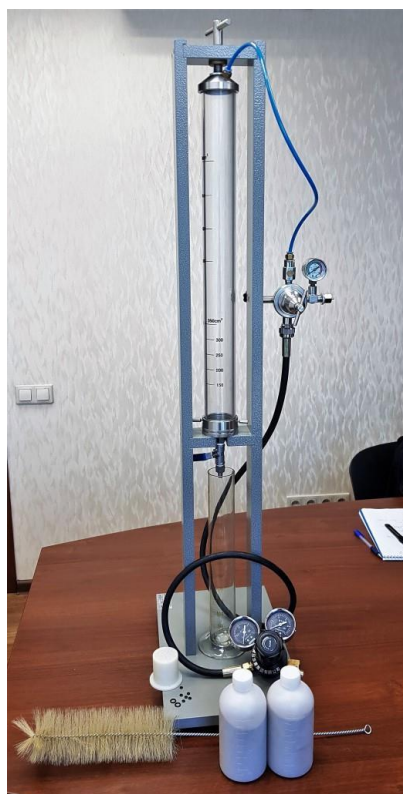
Рис. 1. Установка по определению проницаемости керна.
