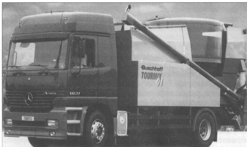
Рис. 27. Мобільний комбікормовий агрегат TOURMIX 01 фірми «Buschhoff»
