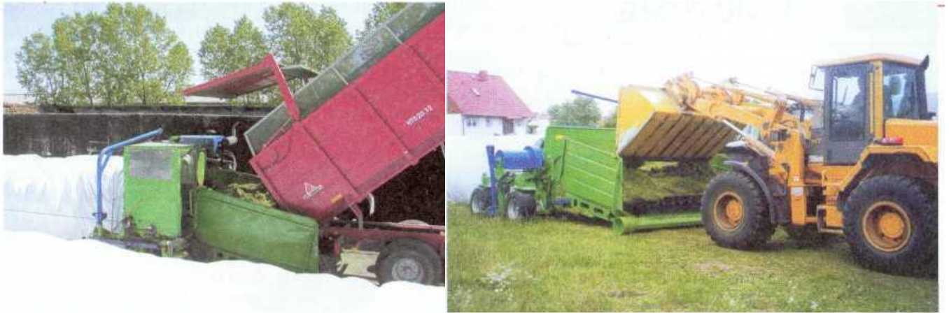
Рис.11. Процес вивантаження силосованої маси у прес-ущільнювач
