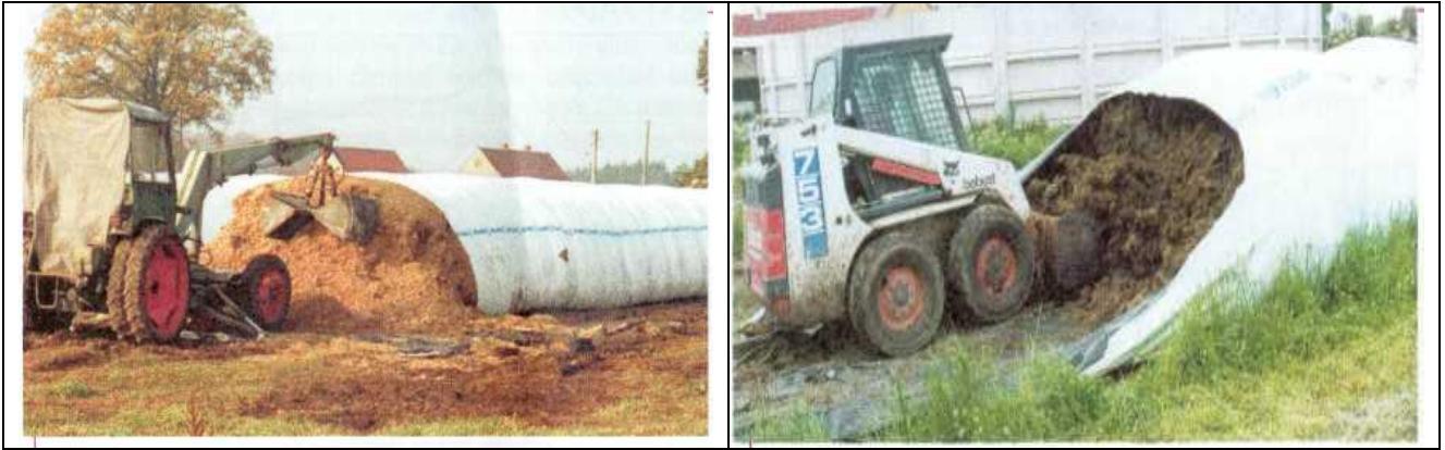
Рис. 15. Техніка для вивантаження корму з рукавів
