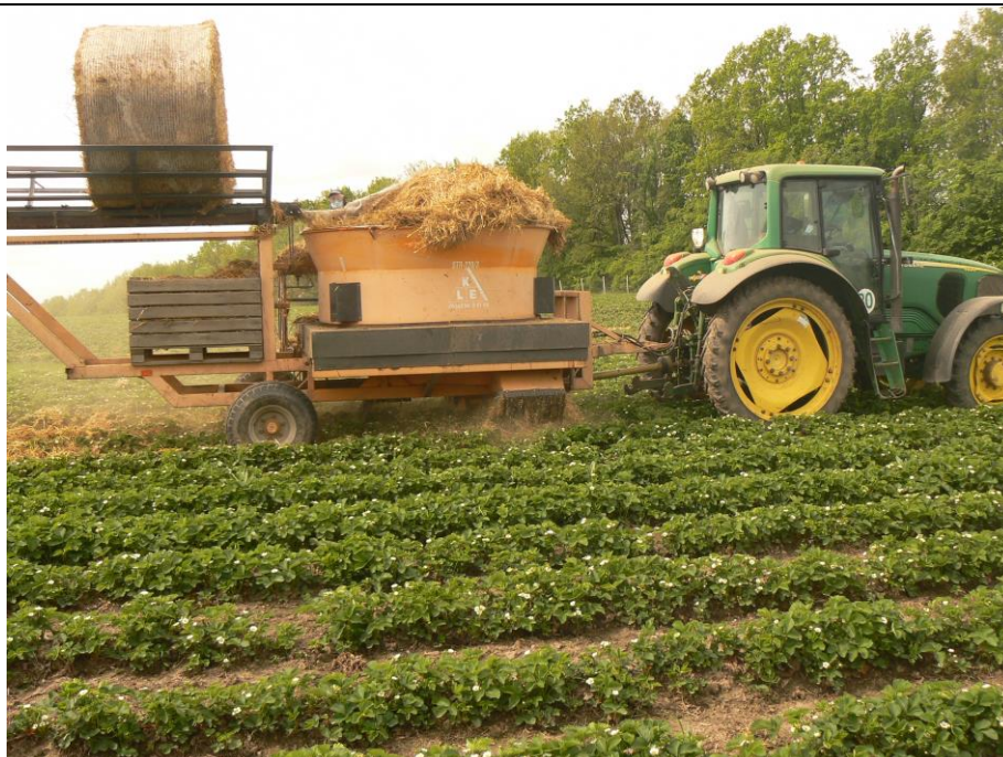
Рис. 3. Агрегат для внесення мульчі в дії
