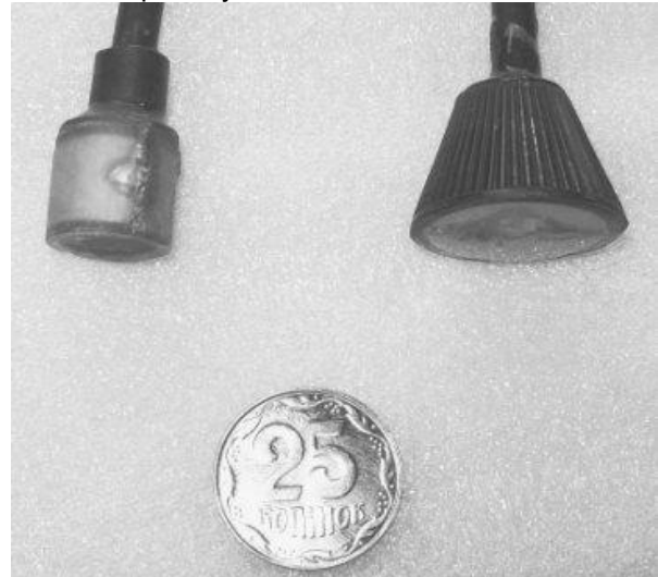
Рис. 1. Зразки вимірювальних гідрофонів з циліндричним та дисковим п'єзоелементами
