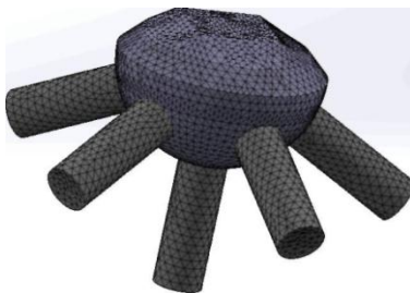
Рис. 4 – Трехмерная модель зерно-связка с изношенным зерном
