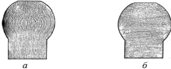
Рис. 5. Волокниста макроструктура в меридіональному перерізі сферичної заготовки: а - поздовжні волокна; б - поперечні волокна.
