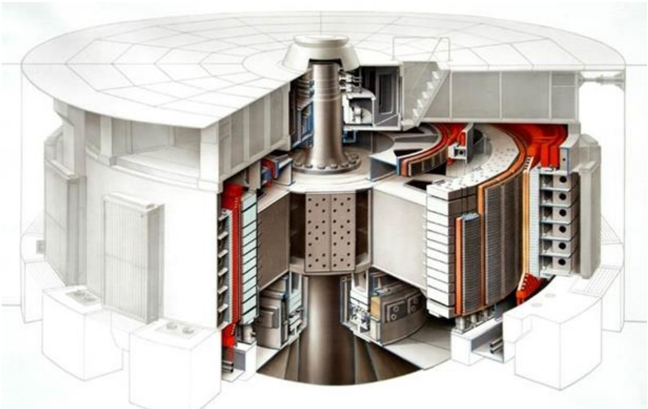
Рис. 2.3 – Загальний вигляд потужного гідрогенератора
