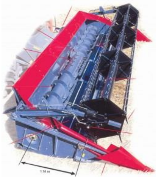
Рисунок 1- Жатка з полотняно-пластинчастим транспортером PAWERFLOW комбайнів MASSEY FERGUSON
