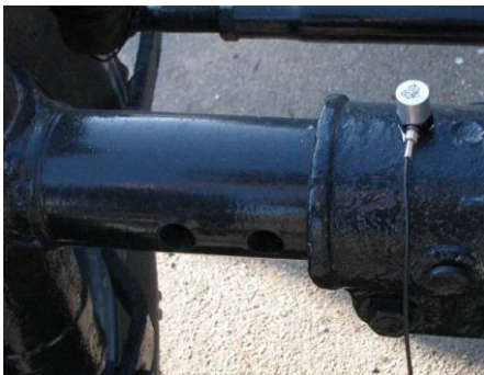
Рис. 2. Установка акселерометра на балці моста трактора МТЗ-80
