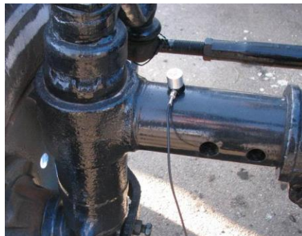
Рис. 3. Установка акселерометра на висувній трубі моста трактора МТЗ-80
