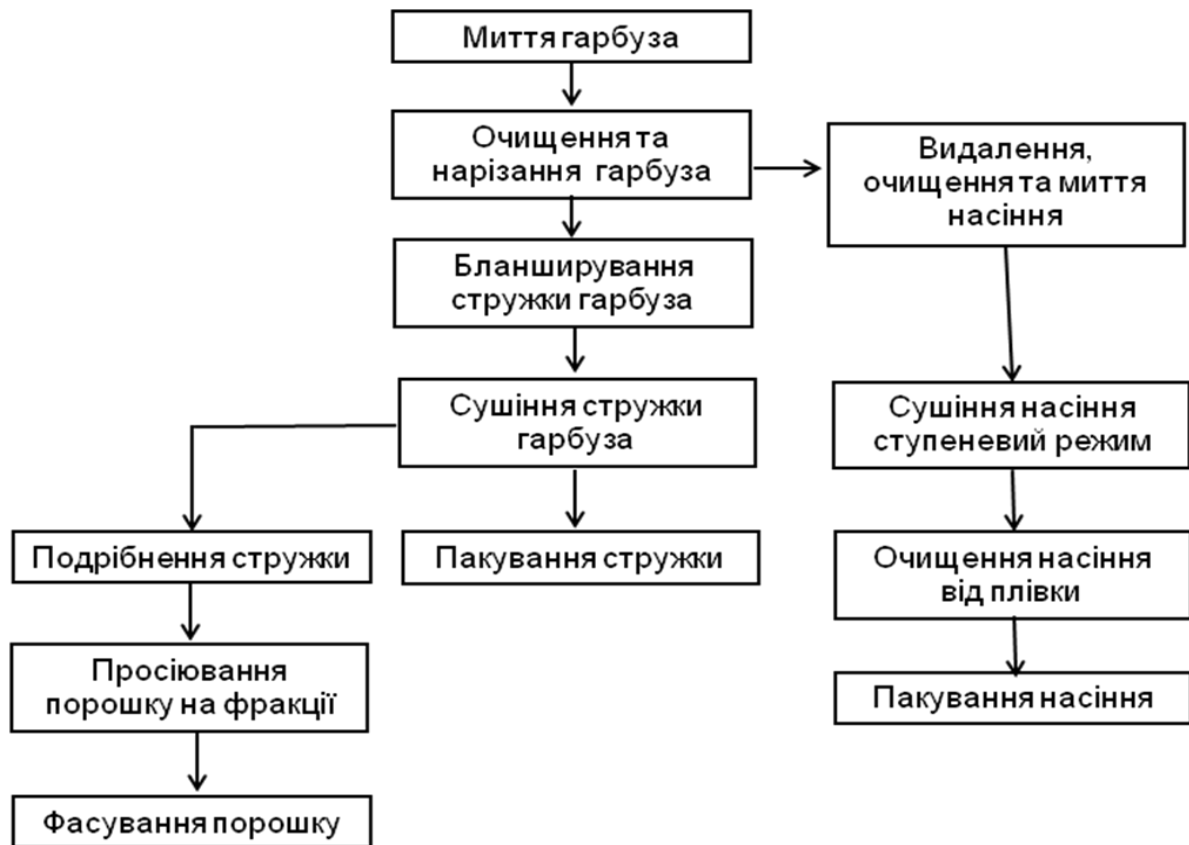
Рис. 4.4. Технологічна схема безвідходної технології переробки гарбуза
