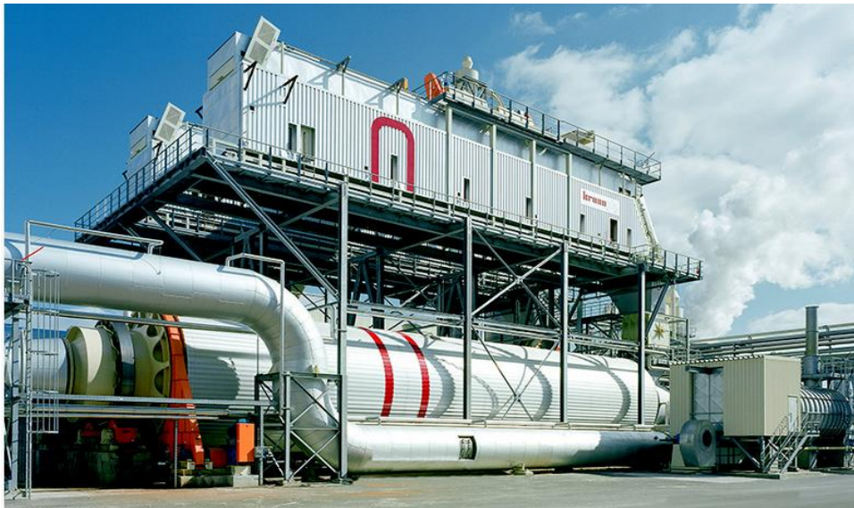
Рис. 1.9. Барабанні зерносушарки фірми Buttner (Німеччина)
